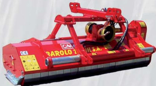
Provedení s hydraulicky ovládaným přesuvem - montáž do předního, nebo do zadního závěsu
